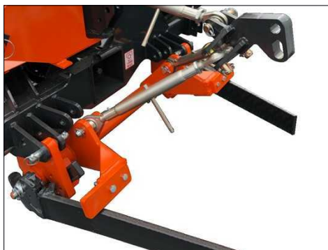
ACC19 - option pour châssis Montage rapide et rigide Accrochage rapide stabilisé (stabilisateur en option)
