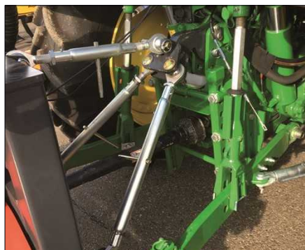
3 points équipés avec stabilisateur NVSTAB3 (option)
